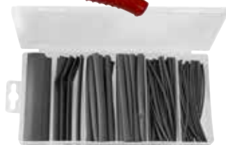
1462855 GUAINE TERMORESTRINGENTI 100PZ Lunghezza 100mm. Materiale autoestinguente VW-1. 6 misure (D/d in mm): 1,6/0,8-2,4/1,2-4,8/2,4-6,4/3,2-9,5/4,8-12,7/6,4. Rapporto di restringimento 2:1
