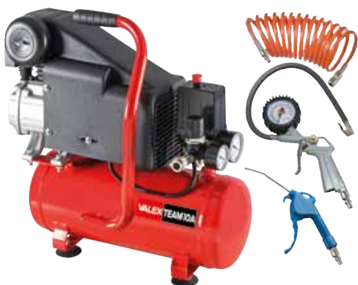
*1551570 COMPRESSORE COASSIALE LUBRIFICATO TEAM 10A Motore 1Hp. Serbatoio 6l. Pressione max 8bar. Con regolatore di pressione. Fornito di pistola con manometro per gonfiaggio pneumatici, pistola di soffiaggio e tubo estensibile lunghezza 5m.
