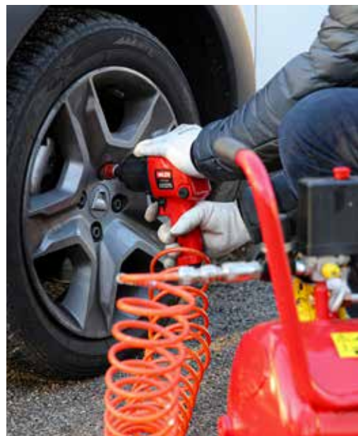
*1551569 COMPRESSORE COASSIALE LUBRIFICATO TEAM 24A Motore 1,5Hp. Serbatoio 24lt. Pressione max. 8bar. Con regolatore di pressione.
